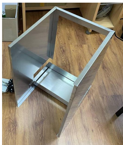
Рисунок 4.9 – Изготовленный из алюминия основной каркас робота
